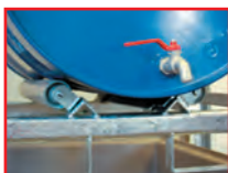
Rouleaux tournants pour fûts 220 litres
