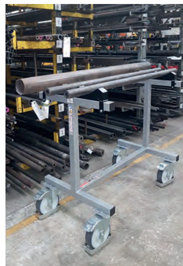
Rouleaux équipés d'un système de blocage L utile 560 mm pour tubes Ø max 159 mm
