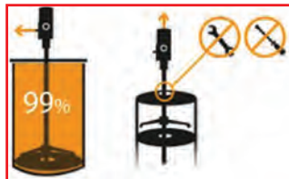
Vide un fût jusqu'à 99% avec ce système
