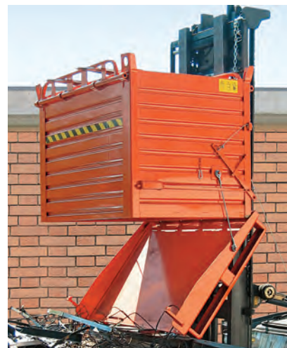
Verrouillage de la benne par poignée.
