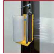
Chariot à pré-étirage à frein mécanique
